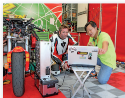
La gestion des réglages moteur se fait aujourd'hui par ordinateur, qu'il s'agisse de motos électriques ou thermiques.
