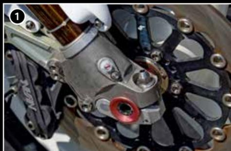
① Le montage complexe au bas de la fourche permettait de faire tomber la roue avant, afin de permettre. ② Entre le réservoir et les réglages de fourche aux allures de temple bouddhiste, se
